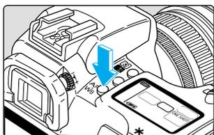
**1** Press the  $\langle \begin{matrix} \text{AF} \\ \text{WB} \end{matrix} \rangle$  button. (  $\odot 6$  )
