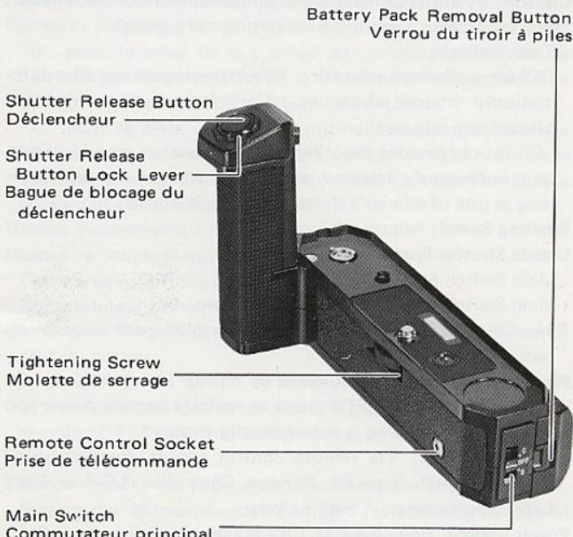
Le moteur d'armement F, destiné au Canon F-1, est un dispositif qui transporte automatiquement le film et arme l'obturateur, en image par image ou en continu à une cadence de deux images/seconde. Il se distingue par deux déclencheurs, l'un pour la prise de vue en position horizontale, l'autre pour la prise de vue en position verticale, et par une prise de télécommande.
